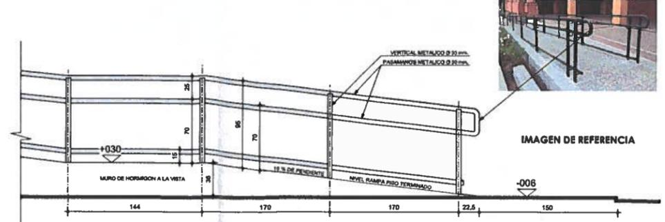
**ELEVACION RAMPA TRAMO TIPO** ESC. 1 / 25
